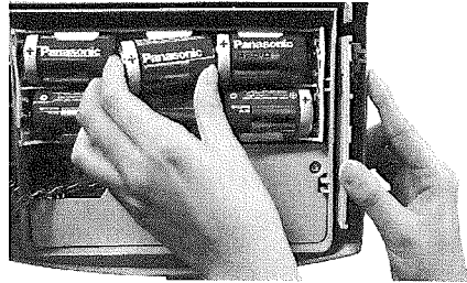
第4図 乾電池の入れ方
